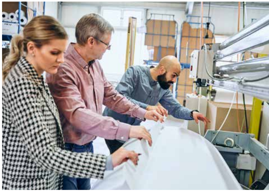
Kristin und Jürgen Zinsmeister zusammen mit Aykut Yalcin beim Qualitätscheck des Rohpapiers und Einrichten der Umrollmaschine
